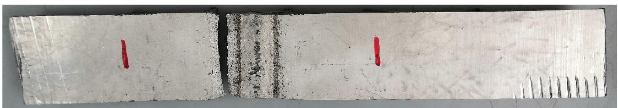
Obr. Místo přetržení vzorku 7.
