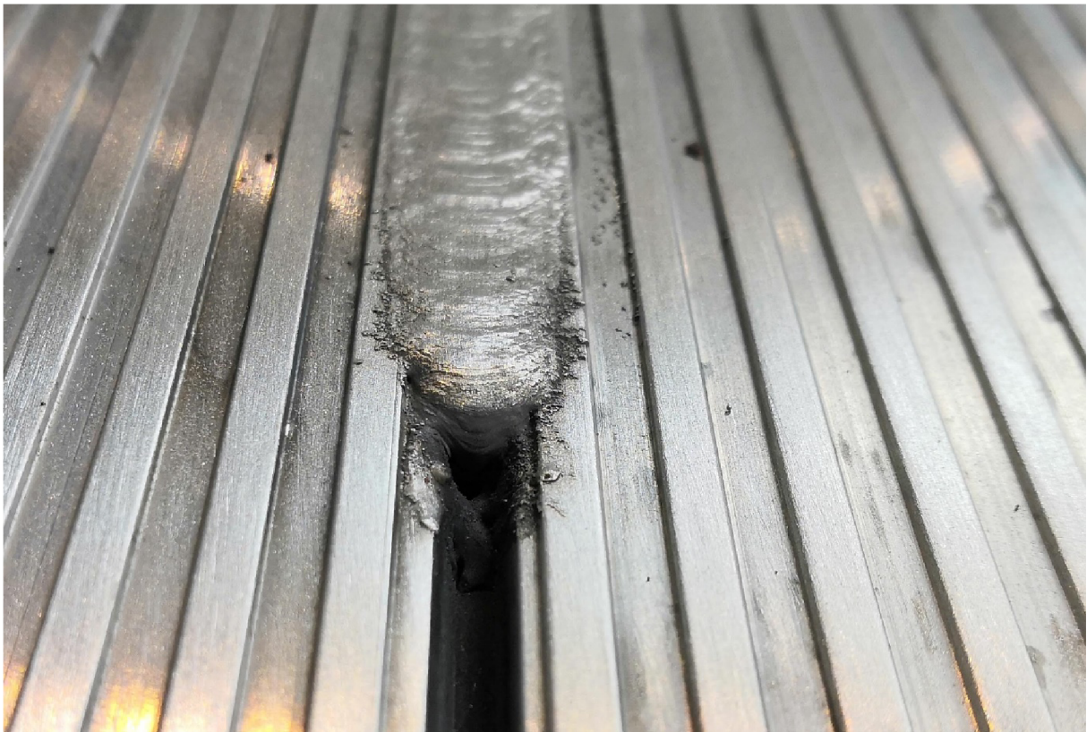
Obr. 5.13 Studený spoj na začátku svaru.
