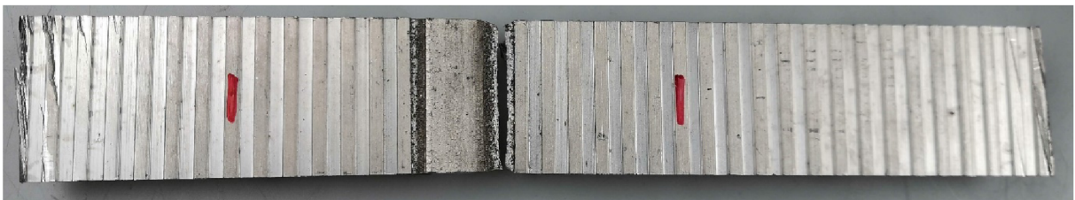
Obr. Místo přetržení vzorku 3.
