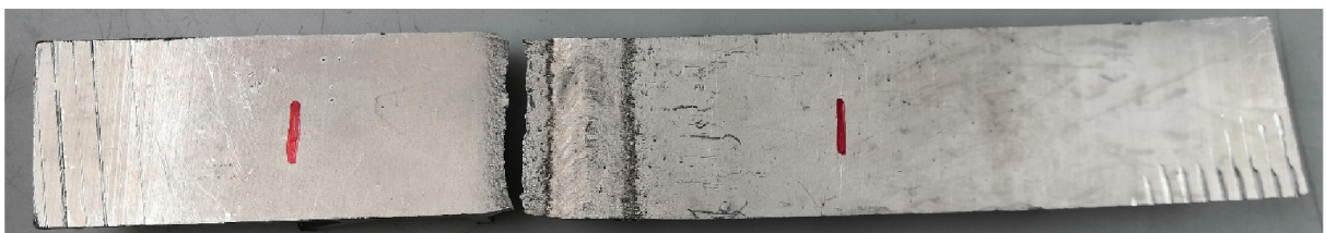
Obr. Místo přetržení vzorku 8.
