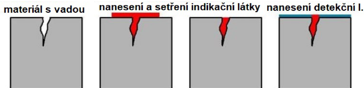
Obr. 4.8 Schéma kapilární metody [66].
