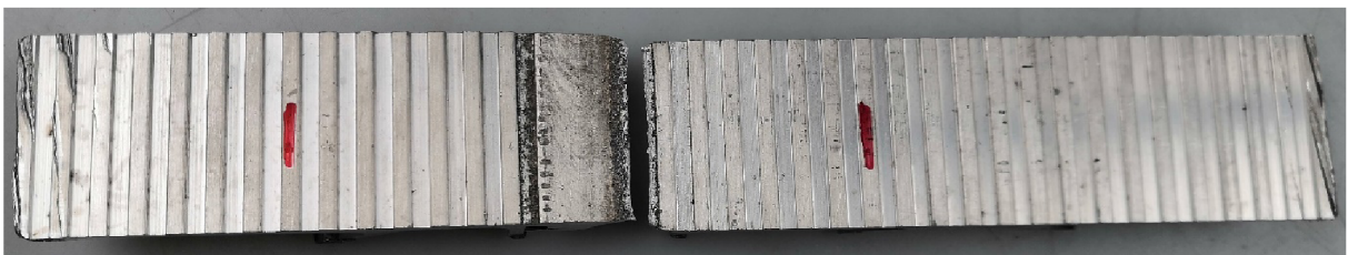
Obr. Místo přetržení vzorku 4.
