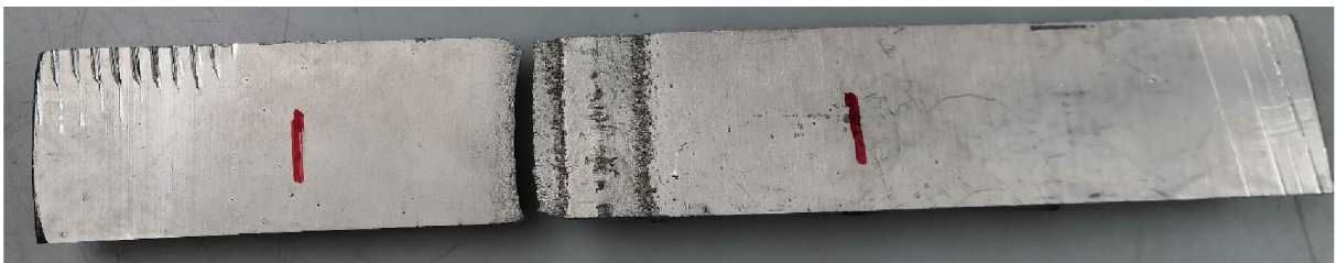
Obr. Místo přetržení vzorku 6.
