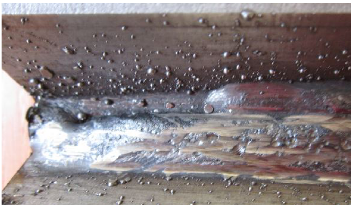
Obr. 4.2 Rozstřík svarového kovu [44].
