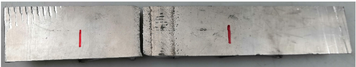
Obr. Místo přetržení vzorku 5.
