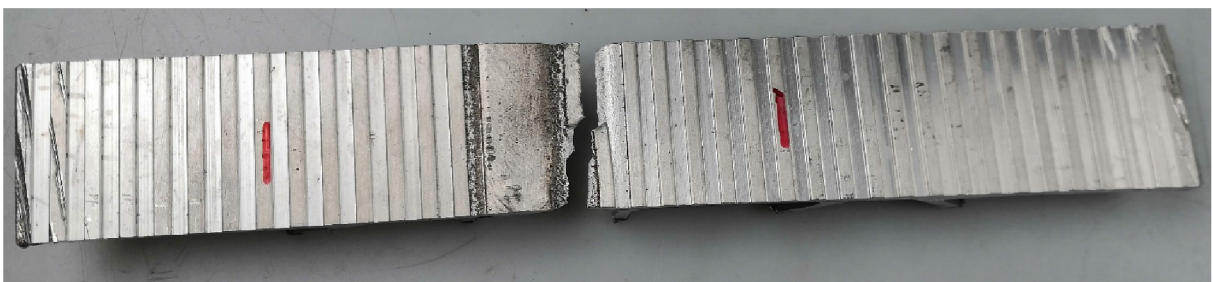
Obr. Místo přetržení vzorku 2.
