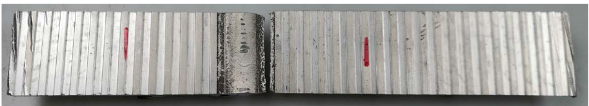
Obr. 5.7 Místo přetržení vzorku 1.
