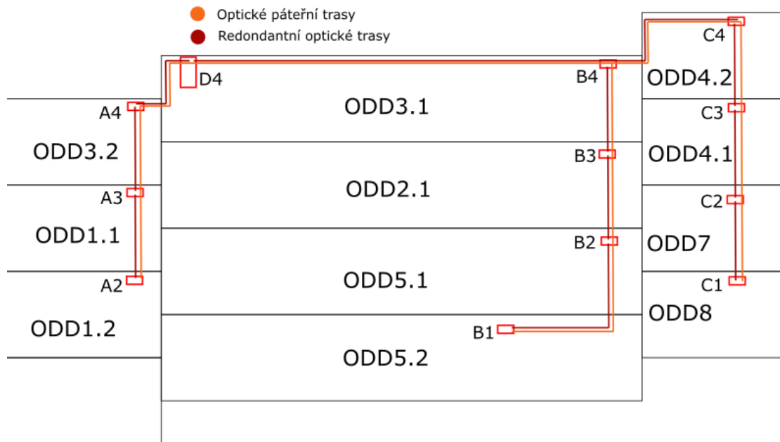
Obrázek č.9 Návrh optických a redundantních tras (Zdroj: vlastní zpracování)
