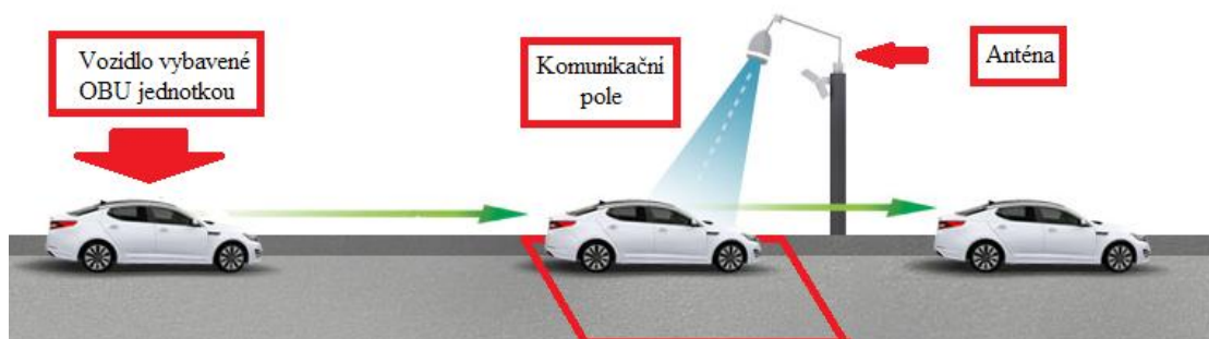
Obr. 4: Schéma principu technologie DSRC
