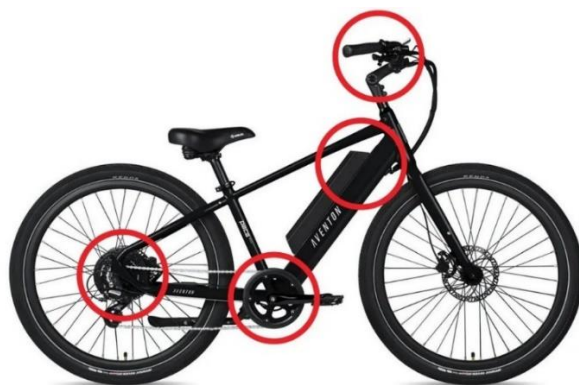
Elektrokolo s vyznačenými elektrickými částmi
