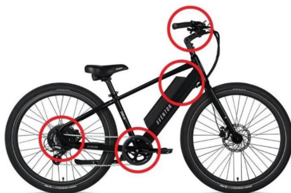
Elektrokolo s vyznačenými elektrickými částmi
