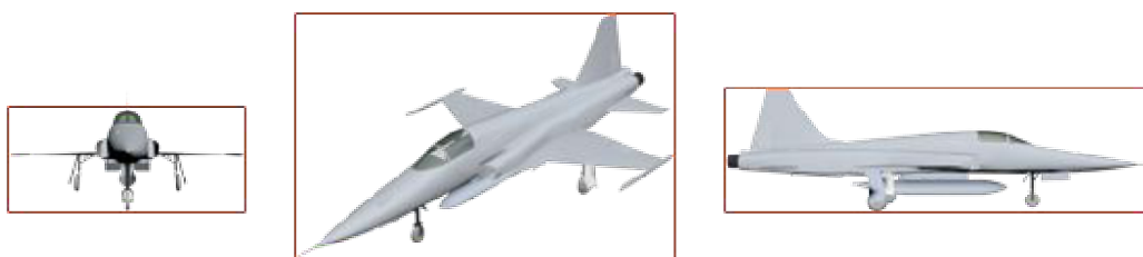
Obrázek 2.4: Objekt může mít ve stejné vzdálenosti různě velký bounding box .
