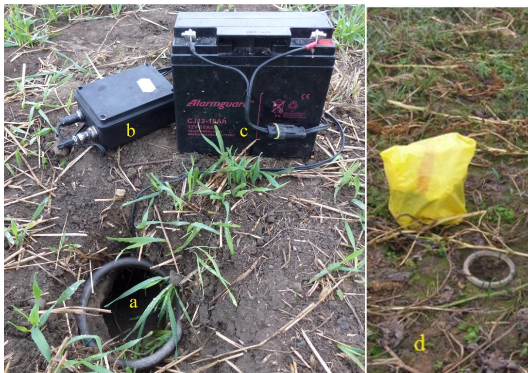
Obrázek 6 Automatický systém registrace jedinců: kruhová anténa (a), čtečka (b), akumulátor (c), nachystané čtecí zařízení (d).
