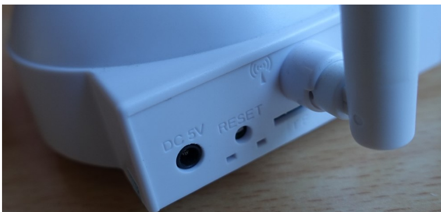
Obrázek 30: Konektor napájení a tlačítko reset IP kamery
