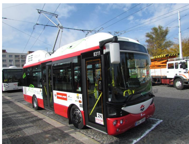
Obr. 3 Průběžně dobíjený E-bus Siemens/Rampini [4]
