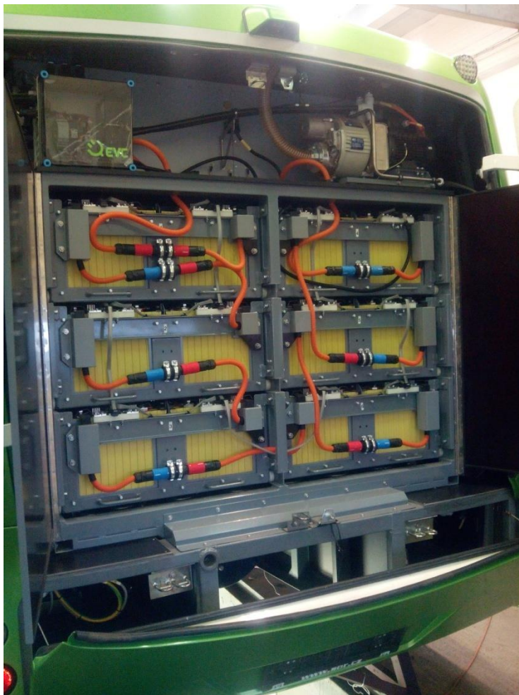
Obr. 29 Bateriový box elektrobusu SOR EBN 11
