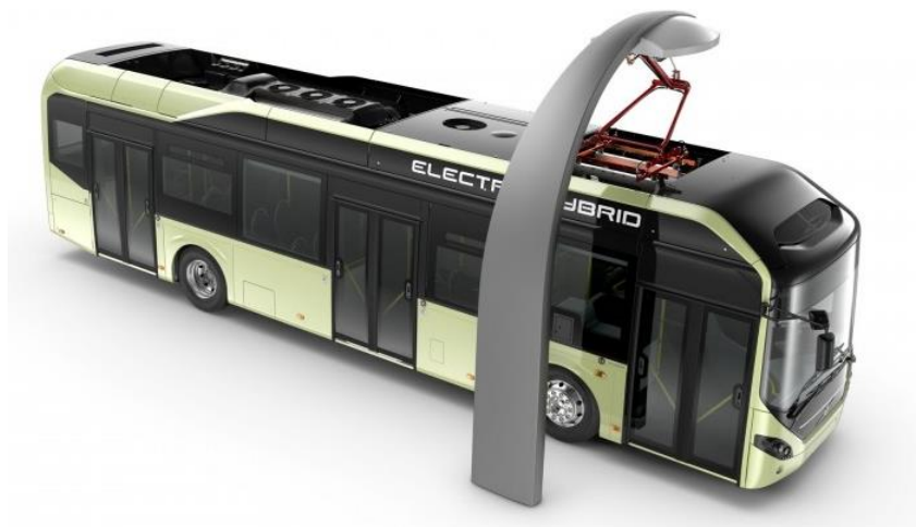
Obr. 2 Volvo 7900 v dobíjecí stanici [4]
