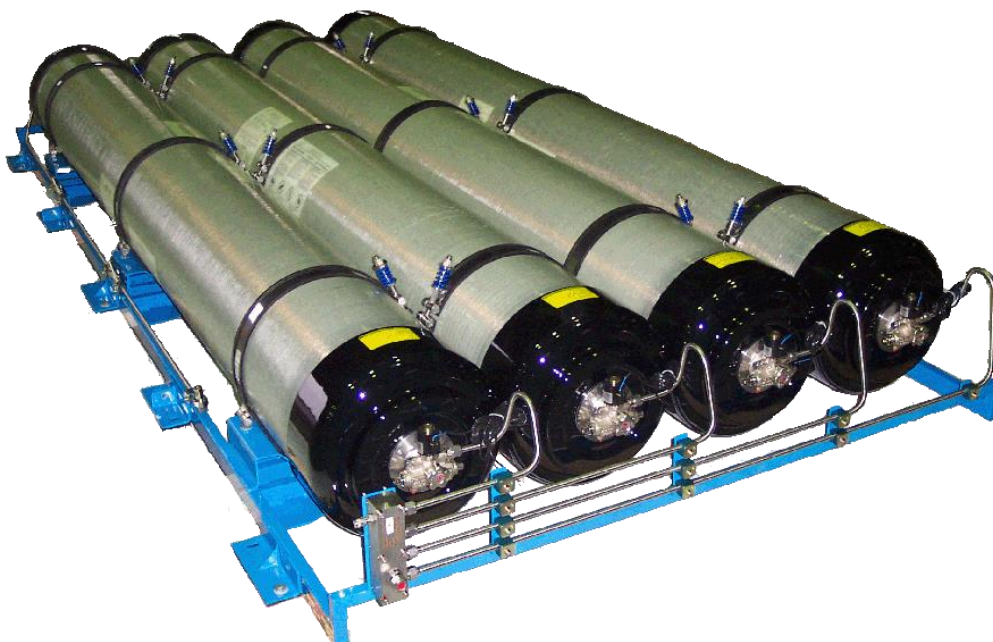
Obr. 20 Střešní nosič vysokotlakých nádob pro autobus SOR s pohonem na CNG (kapacita 4 x 310l)
