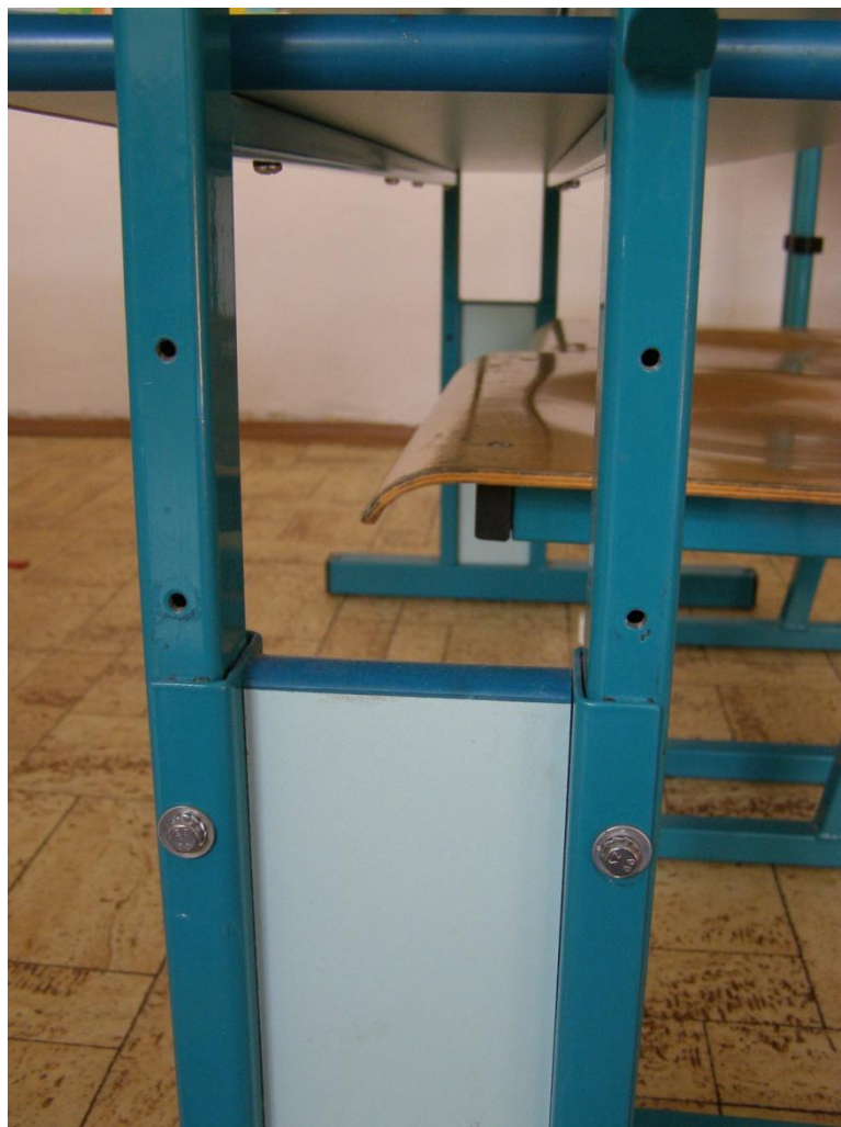
Obr. 52 - Boční pohled na konstrukci výškového nastavení lavice
