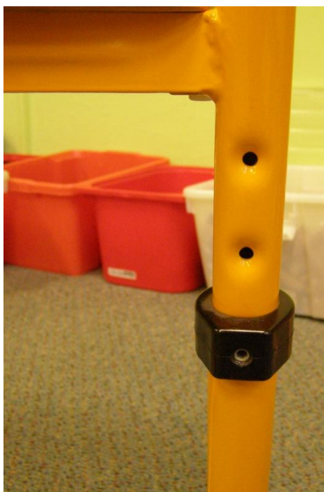
Obr. 45 - Detail spoje výškového nastavení židle
