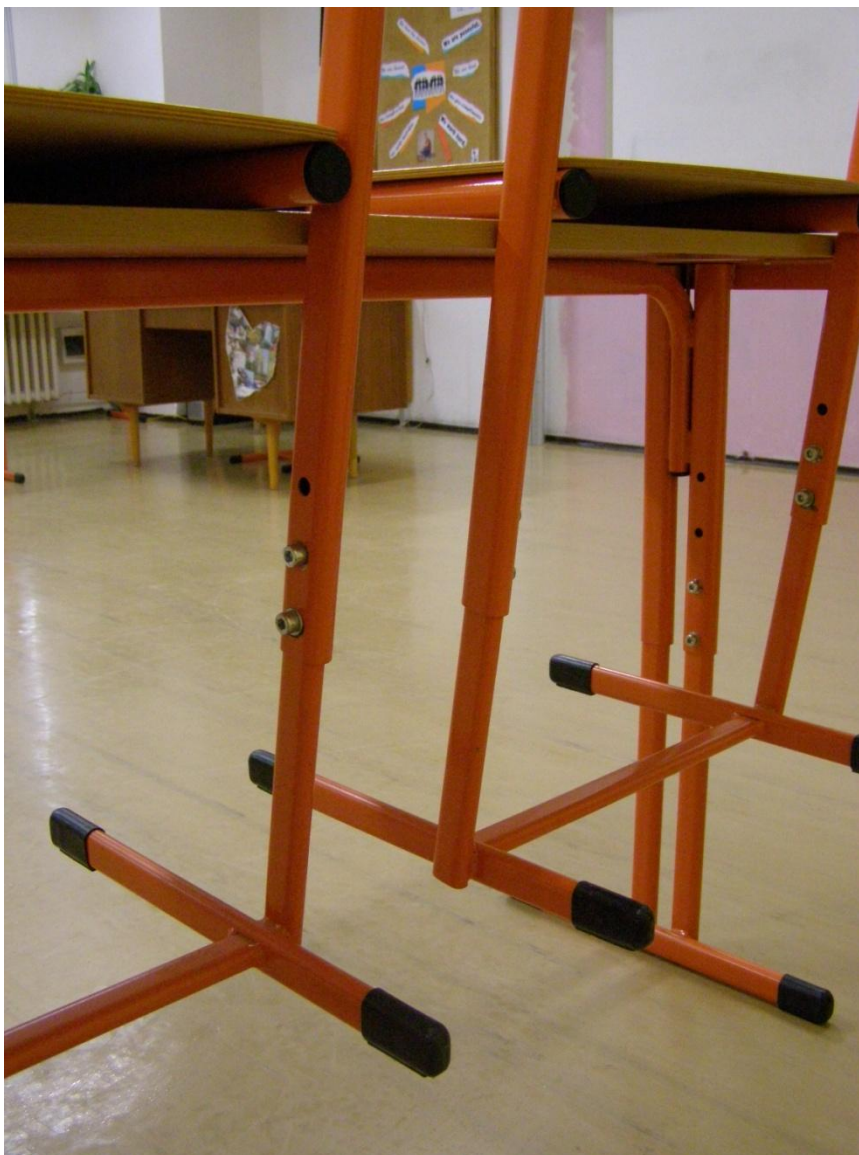
Obr. 56 - Výsuv novějšího typu lavice
