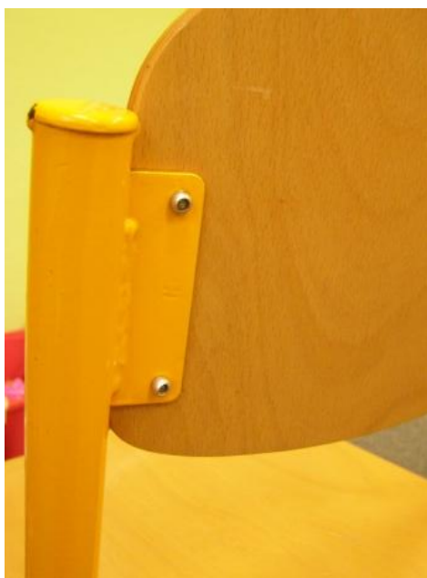
Obr. 46 - Detail hliníkového nýtu stolu
