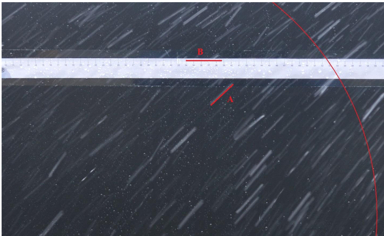
Obr. 12 Ukázka stanovení dráhy kapky. A - obkreslená kapka, B – transponování obkreslené kapky z bodu A na měřítko.
