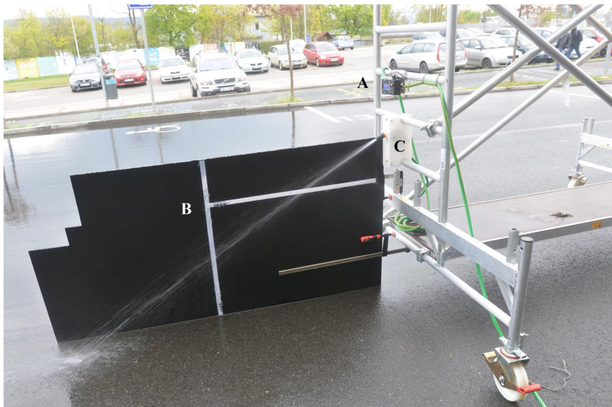
Obr. 9 Měřící pracoviště pro možnosti focení rozptylu, velikosti a rychlosti kapek.
