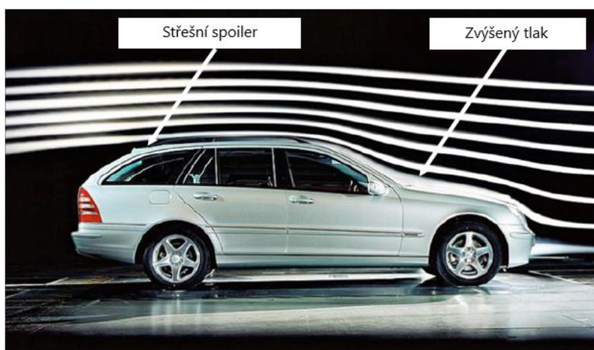
Obrázek 54: Proudění vzduchu kolem vozidla v aerodynamickém tunelu
