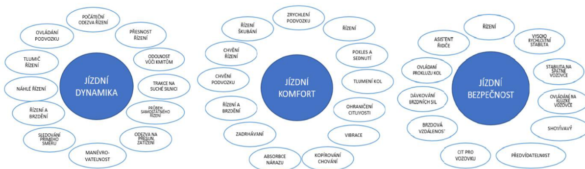
Obrázek 24: Faktory určující hodnocení podvozku s ohledem na jízdní dynamiku, jízdní komfort, jízdní bezpečnost
