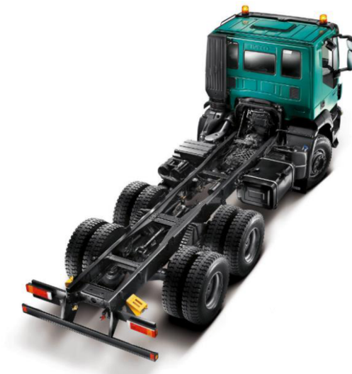
Obrázek 5: Žebřinový rám nákladního vozidla
