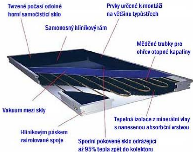
Obrázek 14: Schéma plochého vakuového kolektoru [7]
