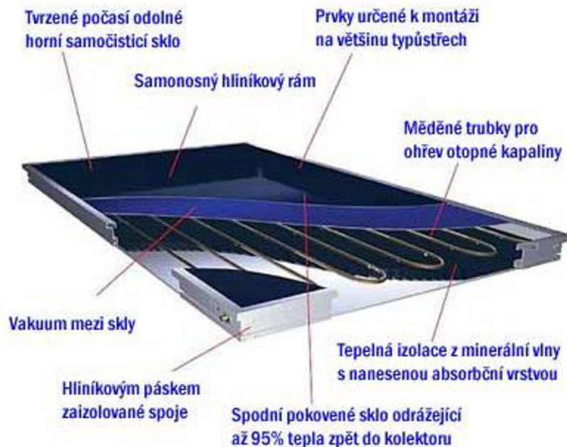
Obrázek 14: Schéma plochého vakuového kolektoru [7]
