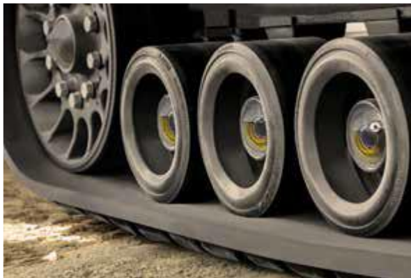
Obrázek č. 21: Okénka olejoměrek v nábojích kol, (agrics.cz, 2020)
