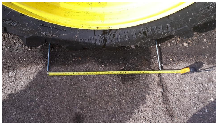
Obrázek č. 28: Měření délky otisku pneumatiky
