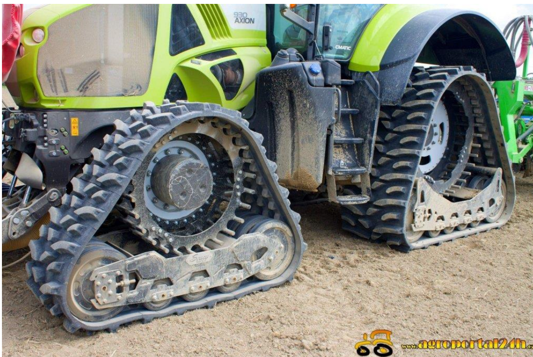
Obrázek č. 15: Pásové jednotky od výrobce Zuidberg, (agroportal24h.cz, 2018)
