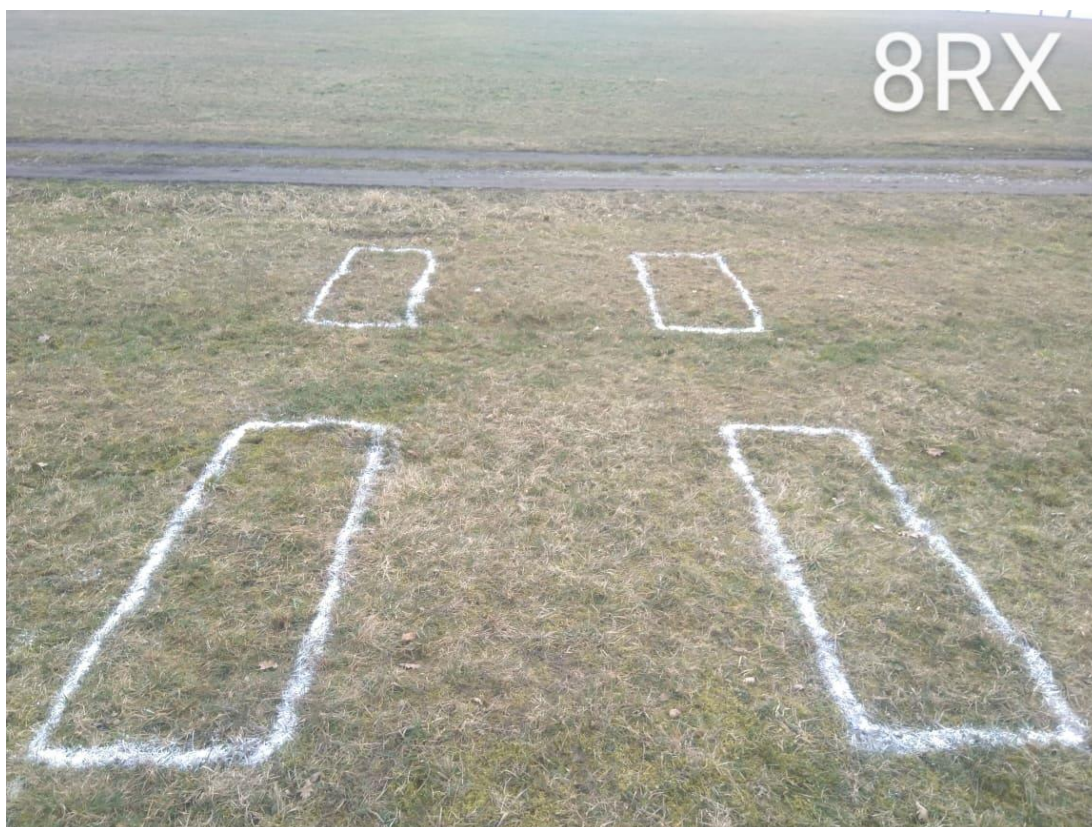
Obrázek č. 43: Vyobrazeny styčné plochy dle zjištěných naměřených hodnot u traktoru John Deere 8RX 410
