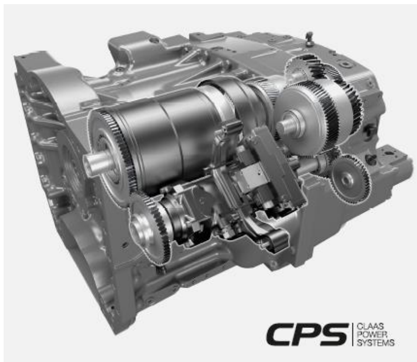
Obrázek č. 23: Plynulá převodovka CMatic, (claas-group.com, 2021)
