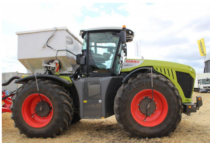
Obrázek č. 17: Systém centrální regulace tlaku v pneumatice použit na traktoru od výrobce zemědělské techniky Claas, (mechanizaceweb.cz, 2018)
