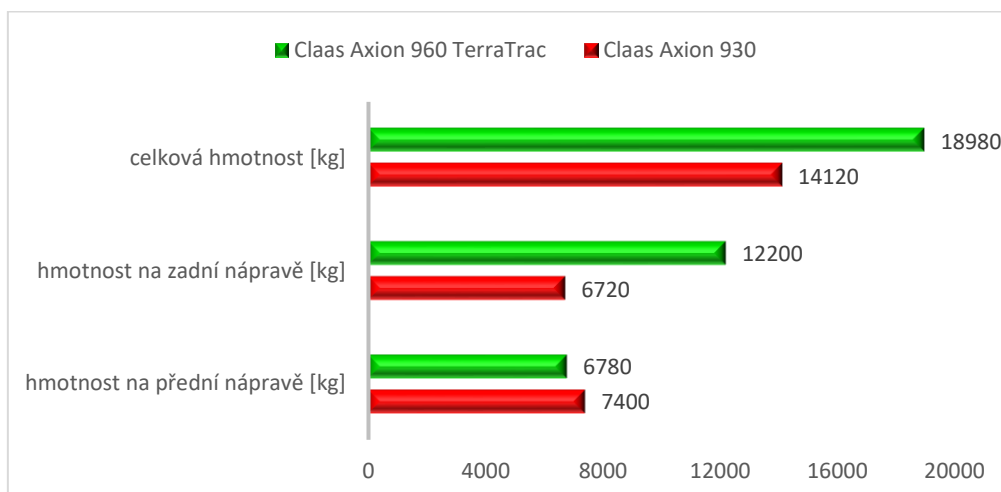
Graf č. 2: Zjištěné hmotnosti traktorů Axion 960 TerraTrac a Axion 930 od výrobce Claas
