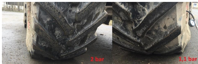
Obrázek č. 36: Změna tvaru bočnice přední pneumatiky při různém tlaku
