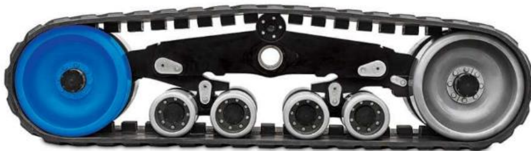
Obrázek č. 11: Konstrukce pásové jednotky pro velkoobjemové vozy, (camso.co, 2021)
