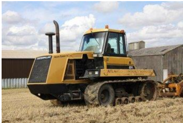
Obrázek č. 5: Caterpillar 65, první sériově vyráběný traktor s gumovými pásy, (agroportal24h.cz, 2020)
