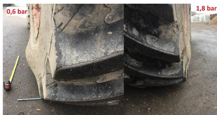
Obrázek č. 37: Změna tvaru bočnice zadní pneumatiky při různém tlaku
