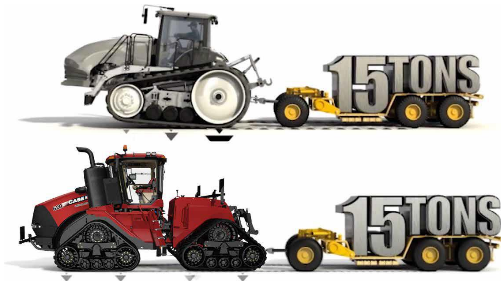
Obrázek č. 14: Rozložení tíhy traktoru u dvoupásového a čtyřpásového podvozku traktoru, (agrics.cz, 2021)
