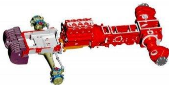
Obrázek č. 6: Bezrámová konstrukce podvozku výrobce Zetor, (agroportal24h.cz, 2019)
