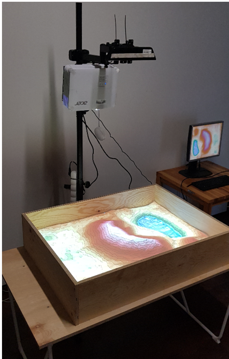
Obr. 3.3: Zrealizovaný systém AR Sandbox s Kinectom, projektorom a sandboxom s pieskom.
