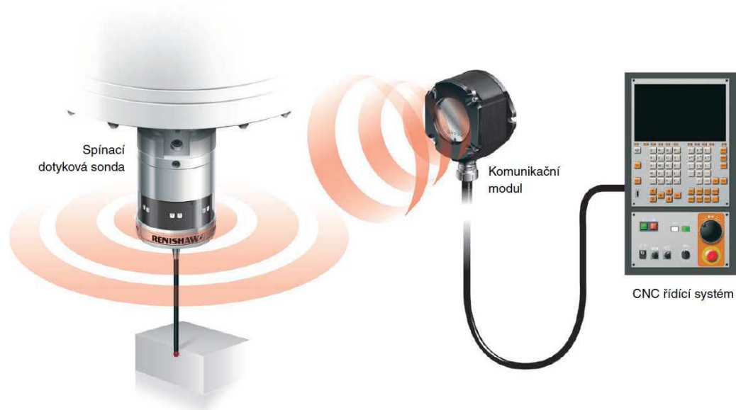
Obr. 6 Systém provedení obrobkové sondy s optickým systémem [9]
