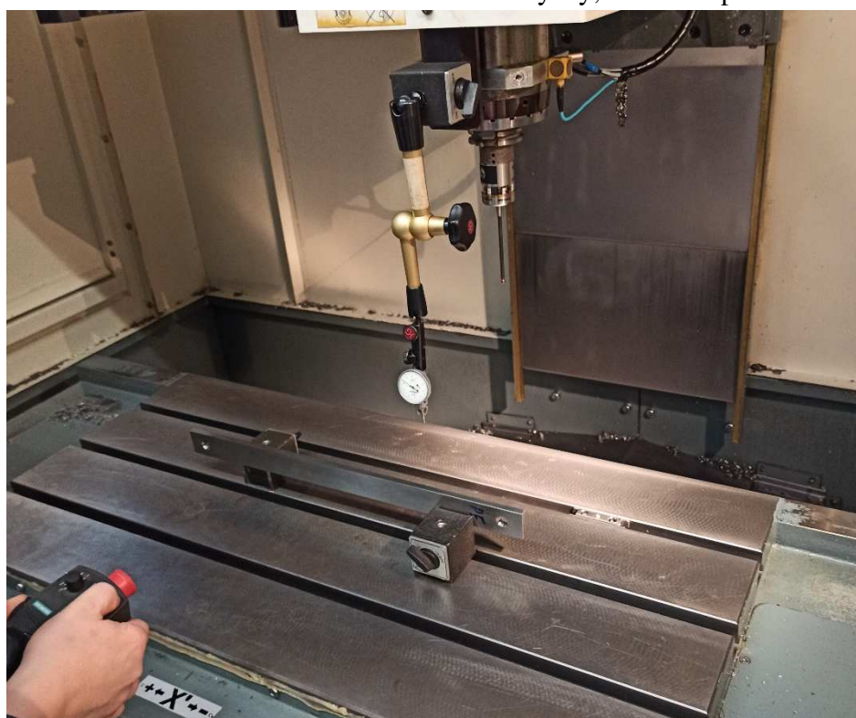
Obr. 16.1.14 Ustavení etalonu pomocí číselníkového úchytkoměru
