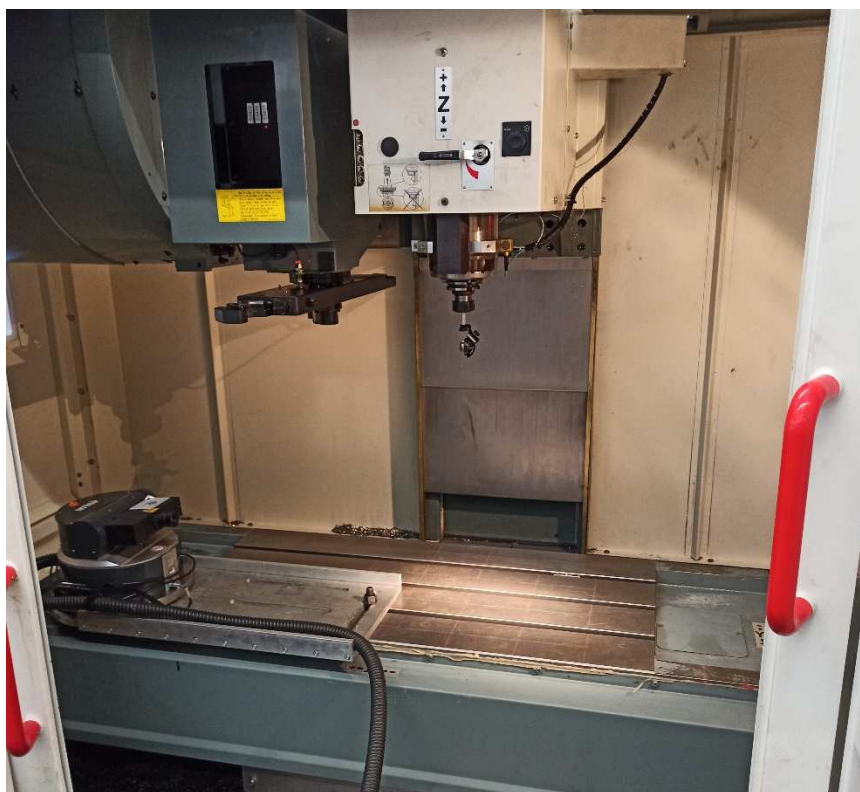
Obr. 16.1.11 Kalibrační měření volumetrické přesnosti stroje
