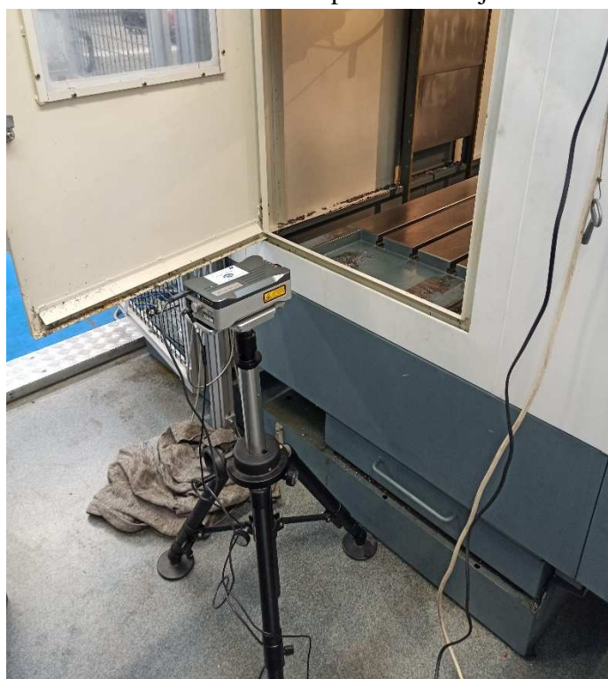
Obr. 16.1.2 Ustavení měřícího zařízení LTC
