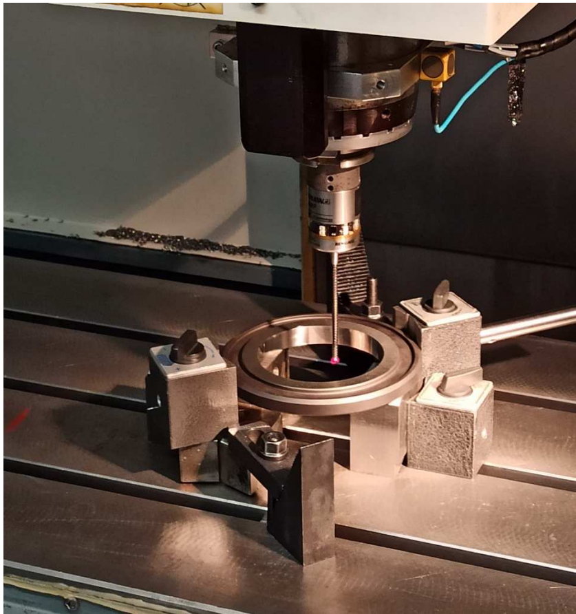
Obr. 16.1.15 Kalibrace průměru doteku v dané konfiguraci stroje
