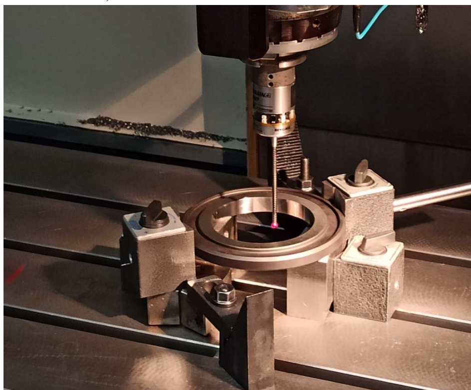
Obr. 55 Kalibrace doteku na kalibračním kroužku
