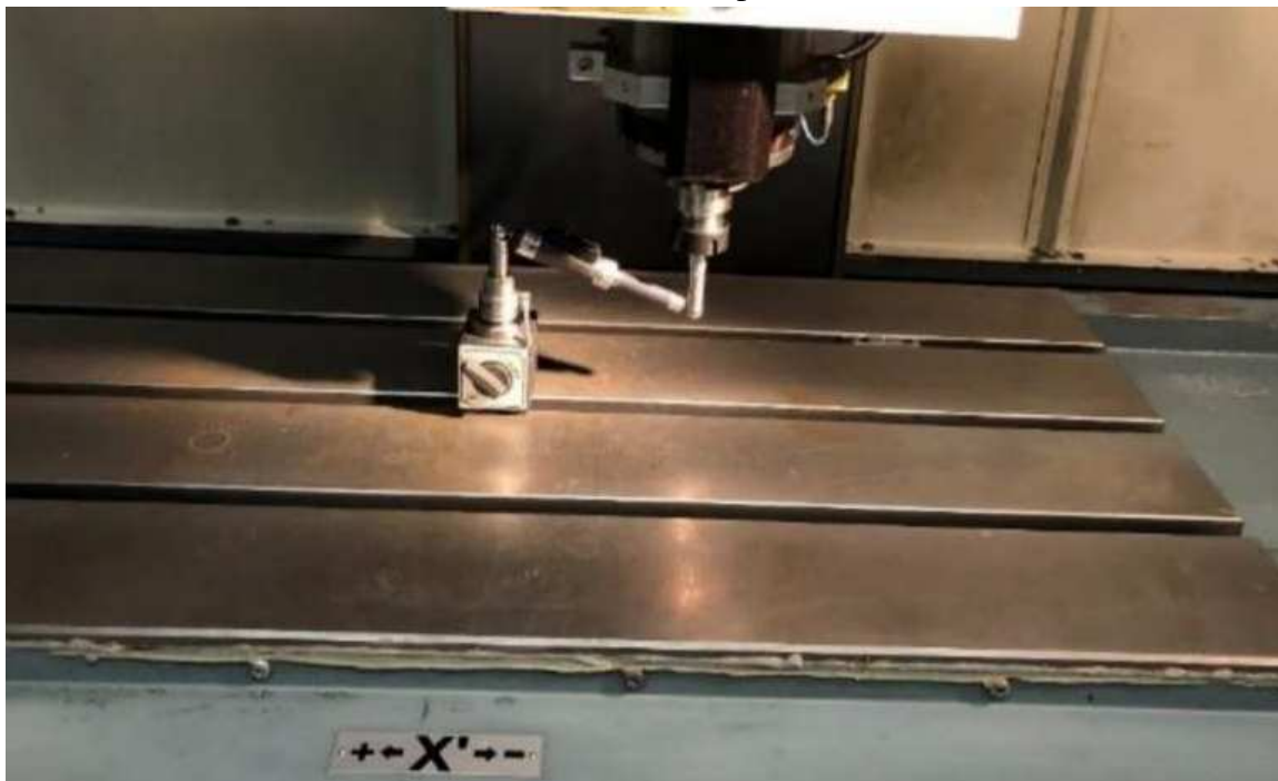
Obr. 16.1.8 Měření kolmosti pomocí Double Ballbar zařízení
