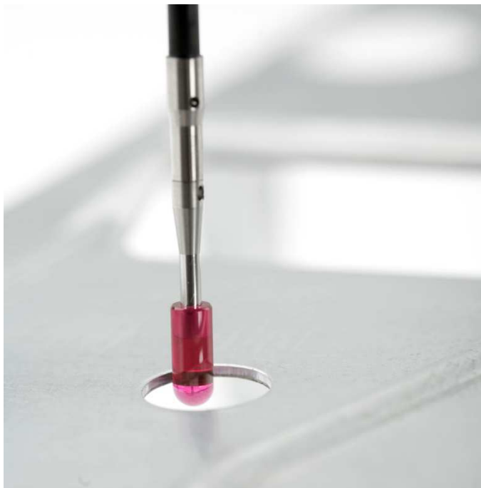
Obr. 9 Válcový dotek během měřicí operace [10]
