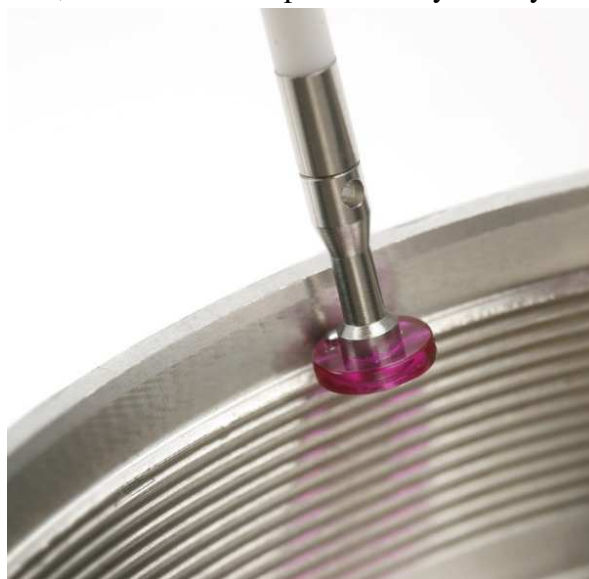
Obr. 10 Diskový dotyk během měřicí operace [10]
