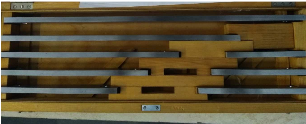
Obr. 27 Johanssonovy měrky uložené v dřevěném boxu
