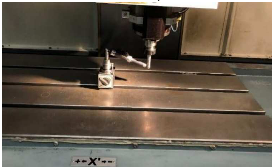
Obr. 16.1.8 Měření kolmosti pomocí Double Ballbar zařízení
