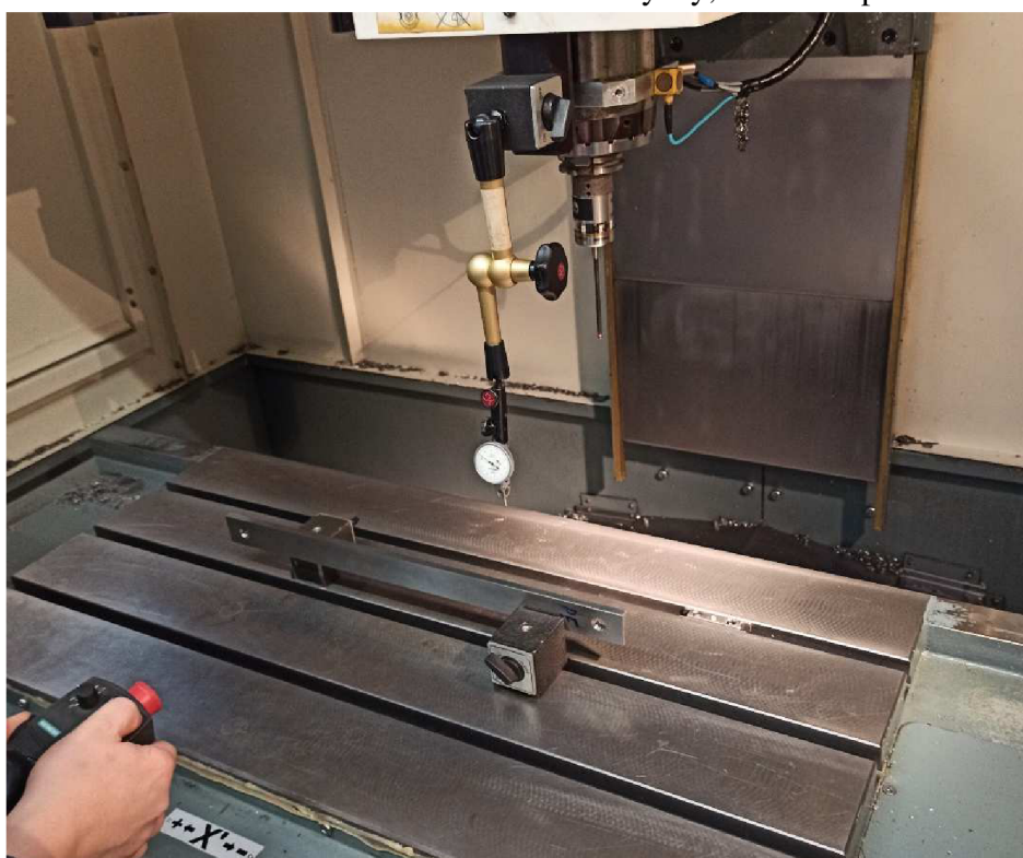
Obr. 16.1.14 Ustavení etalonu pomocí číselníkového úchytkoměru
