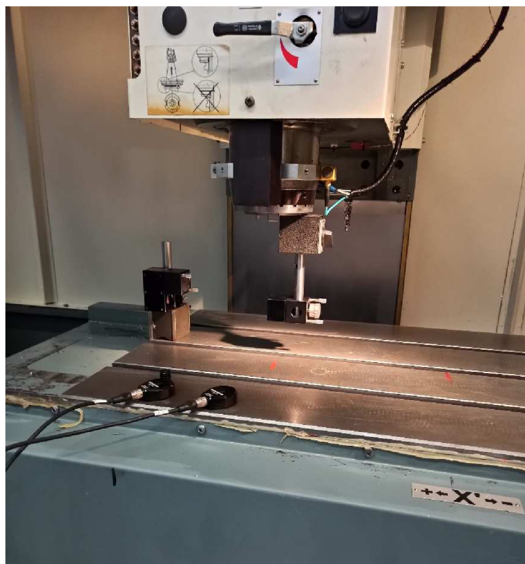
Obr. 16.1.3 Ustavení odražečů a umístění snímačů okolí pro zařízení LTC
