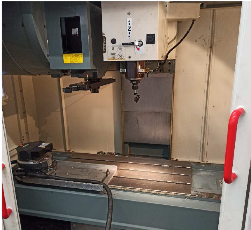
Obr. 16.1.11 Kalibrační měření volumetrické přesnosti stroje
