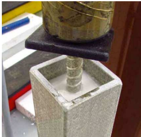
Obrázok 4.1: Zrýchlená skúška FRP výstuže ponorenej do alkalických roztokov so zvýšenou teplotou (prevzaté z [11])
