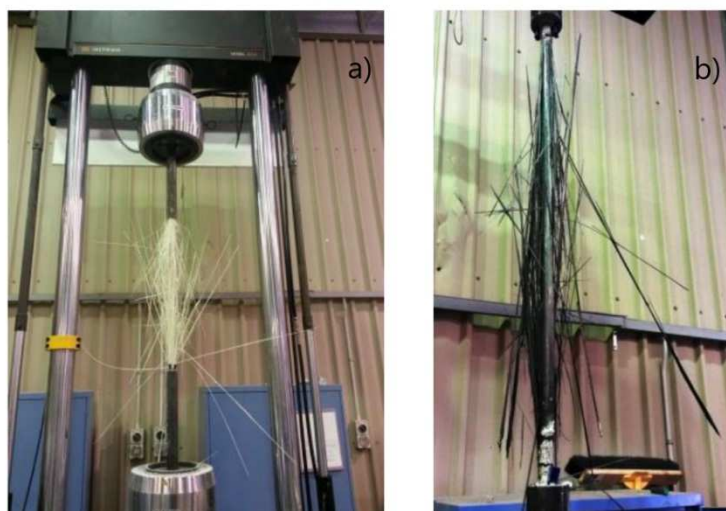
Obrázok 5.2: Fotografie zo skúšok ťahovej pevnosti porušených FRP výstuží: a)GFRP; b)CFRP [16]
