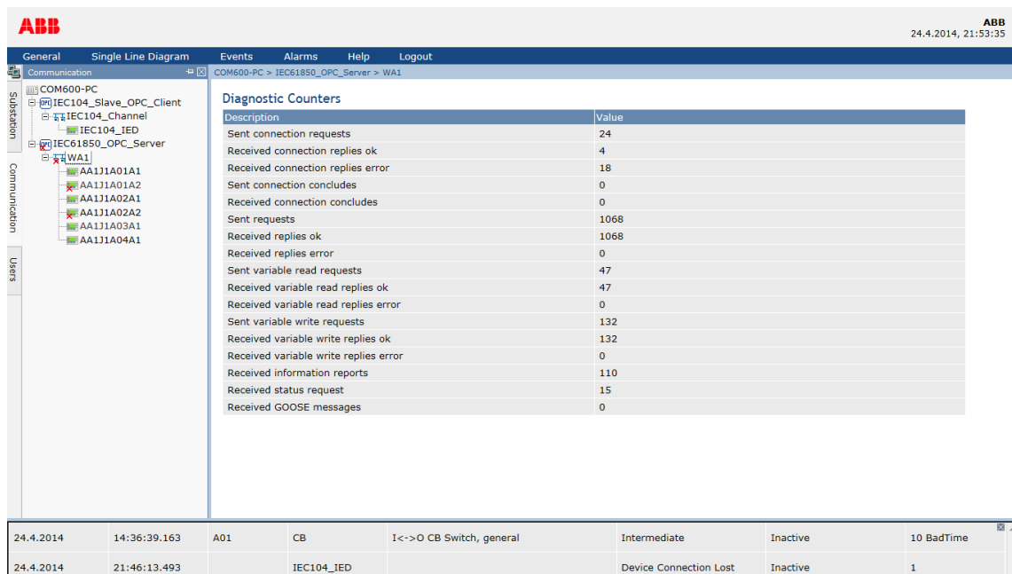
Obrázek 24. Diagnostické okno testování řídicího systému COM600
