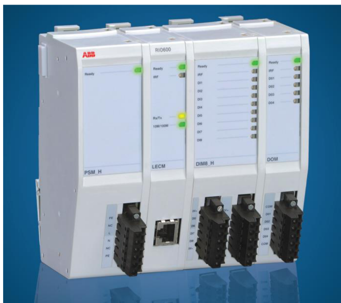
Obrázek 13. Pohled zepředu na rozšiřující periferii RIO600 firmy ABB [14]
