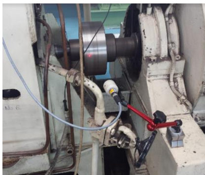
a) umístění tachosondy na spojení
