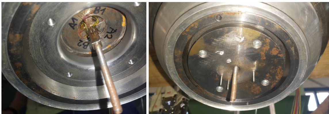
a) umístění tenzometrů na siloměrném členu
