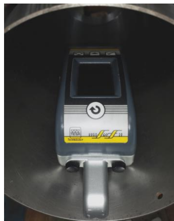
Obr. 70: Měření drsnosti na modelu pomocí drsnoměru
