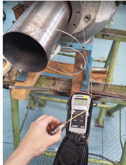
b) těsnostní zkouška odběrů statických tlaků
