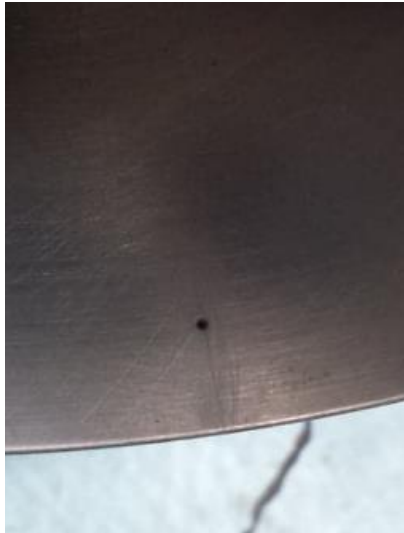
a) detail statického odběru tlaku umístěného na výstupu z difuzoru
