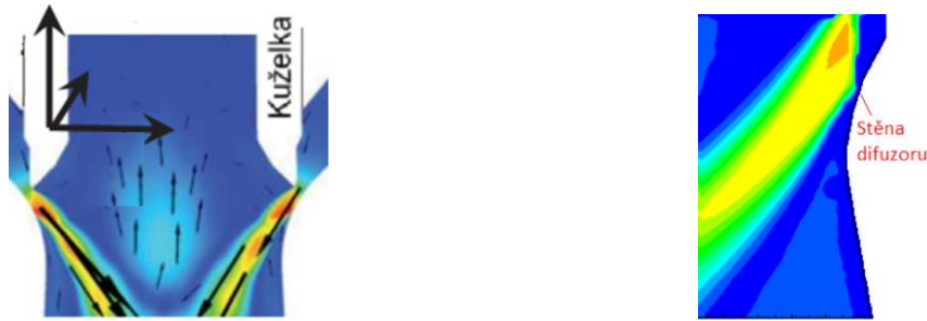
a) odtržení proudění od stěny [27]
