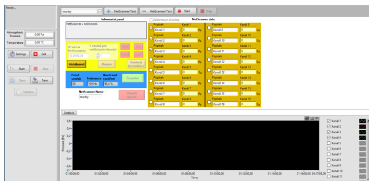
Obr. 86: Grafické rozhraní programu určeného pro sběr dat vytvořeného v prostředí LabVIEW
