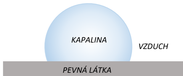
Obr. 1: Vzájemné působení sil kapalina, vzduchu a pevné látky na utváření tvaru kapky vody
