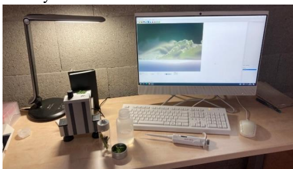
Obr. 19: Zázemí pro měření úhlu smáčivosti (kapková metoda, třibodové měření)
