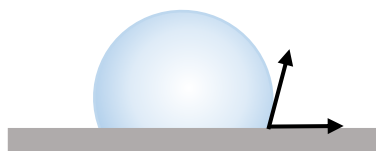
Obr. 3: Kapková metoda; úhel smáčivosti kapky na rovném povrchu
