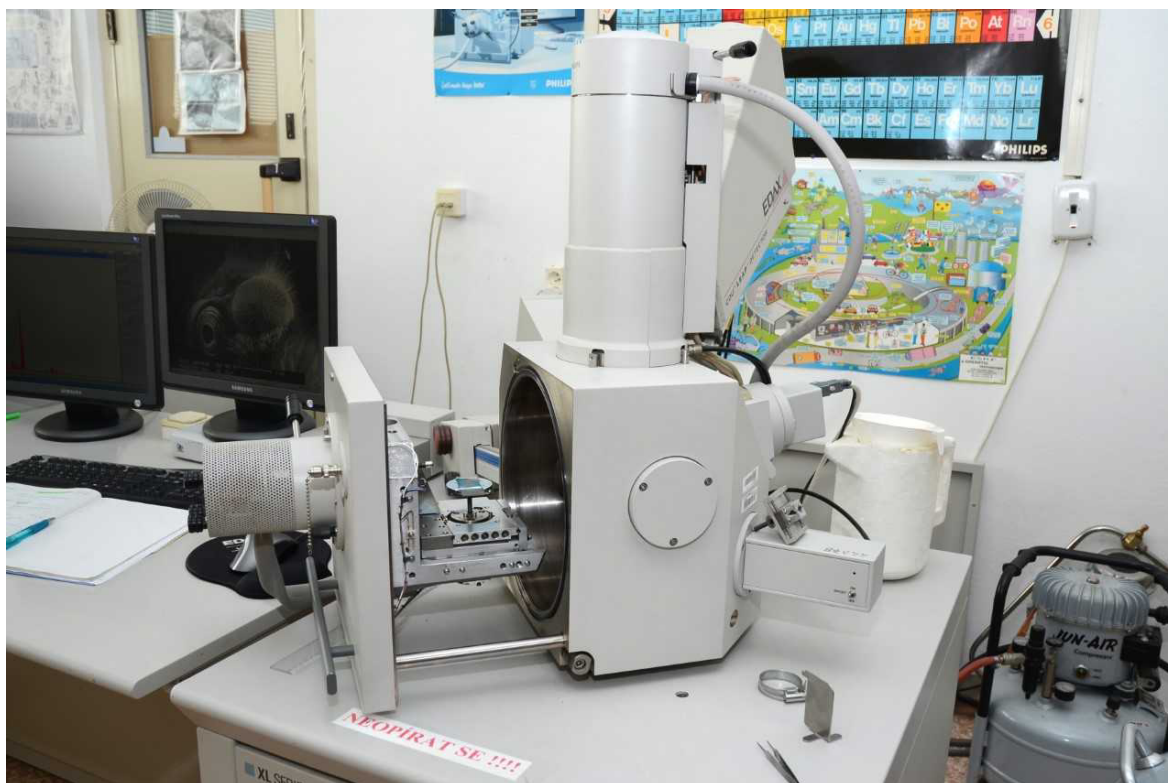
Obrázek 2.2 Skenovací elektronový mikroskop SEM (Quanta FEG 450, FEI) s rentgenovou mikroanalýzou APOLLO X (EDAX).
