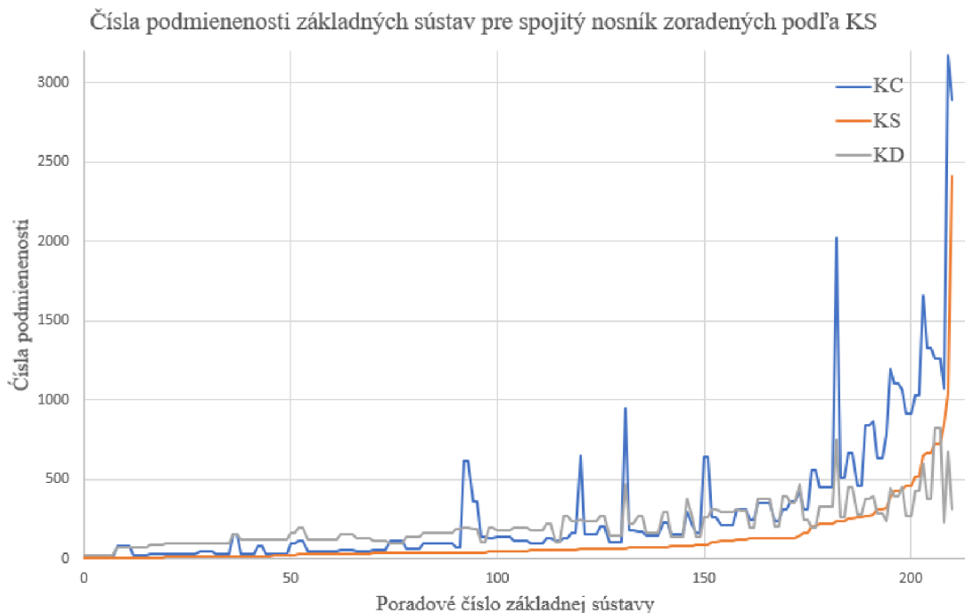
Obr. 2.6: Čísla podmienenosti základných sústav pre spojitý nosník zoradených podľa \kappa_S
