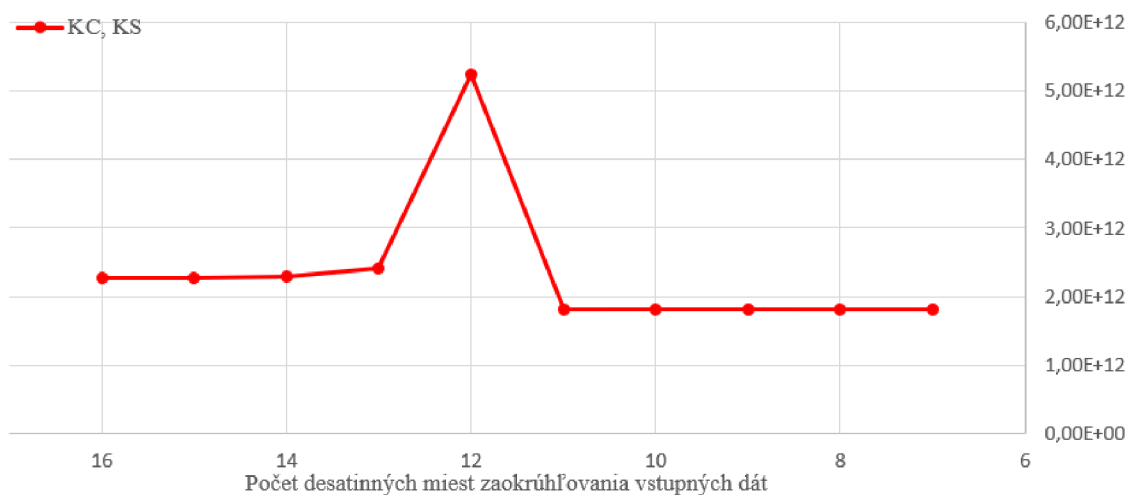
Obr. 2.29: Graf závislosti zmeny čísel podmienenosti na zaokrúhľovaní vstupných dát
