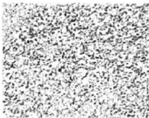
Obr. 3.15 Mikrostruktura s rovnoosými zrný [4]
