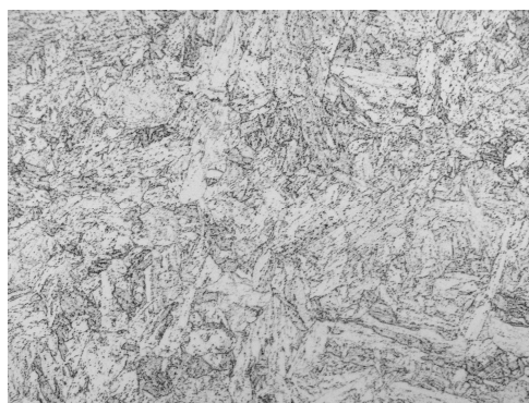
Obr. 3.1 Mikrostruktura oceli Eurofer'97 (1000x)
