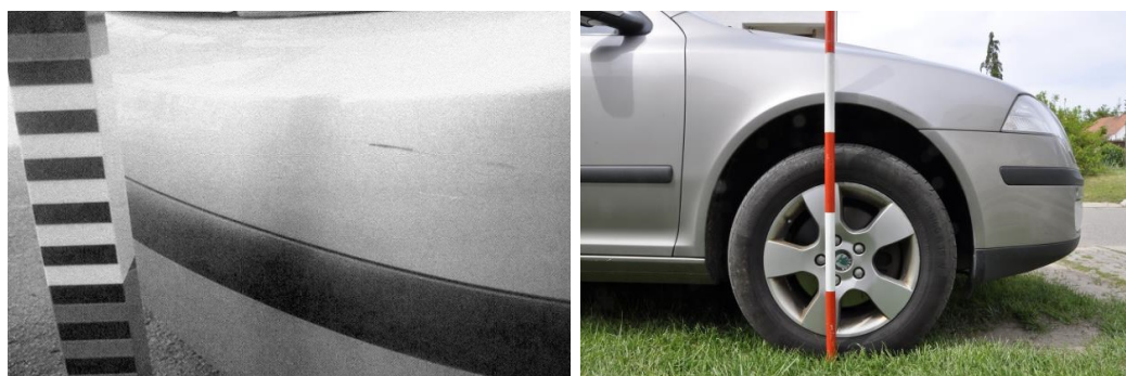
Obr. 5.5: Vlevo vzorová fotodokumentace použití stojanového metru (17). Vpravo příklad správného použití stojanového metru (6, s. 66).
