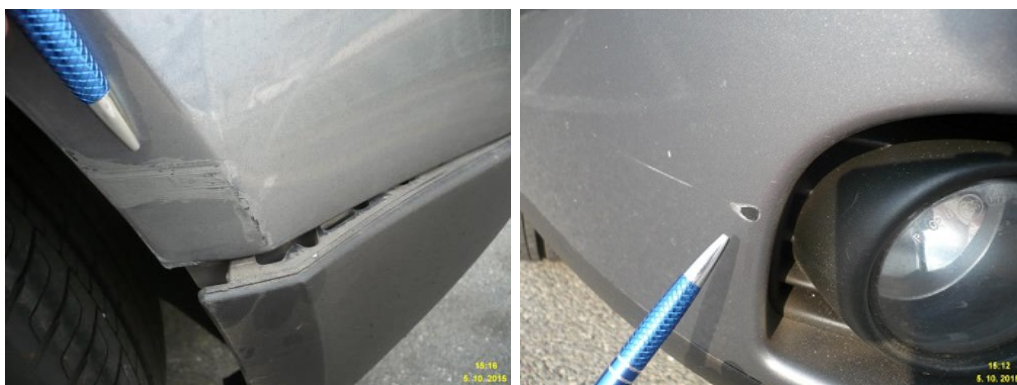
Obr. B.8: Vlevo je patrné poškození zadního nárazníku a předchozí opravy na LZ blatníku. Vpravo je poškození očividně nesouvisející s popsáním průběhem nehody.
