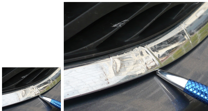
Obr. 5.4: Nedostatečné rozlišení má vliv na kvalitu fotografie a velikost vytištěné fotografie. Vlevo výřez z digitální fotografie, jejíž velikost byla omezena na 300 kB. Vpravo výřez z fotografie s dostatečným rozlišením. Obě fotografie mají nastavení pro tisk 600 bodů na palec.
