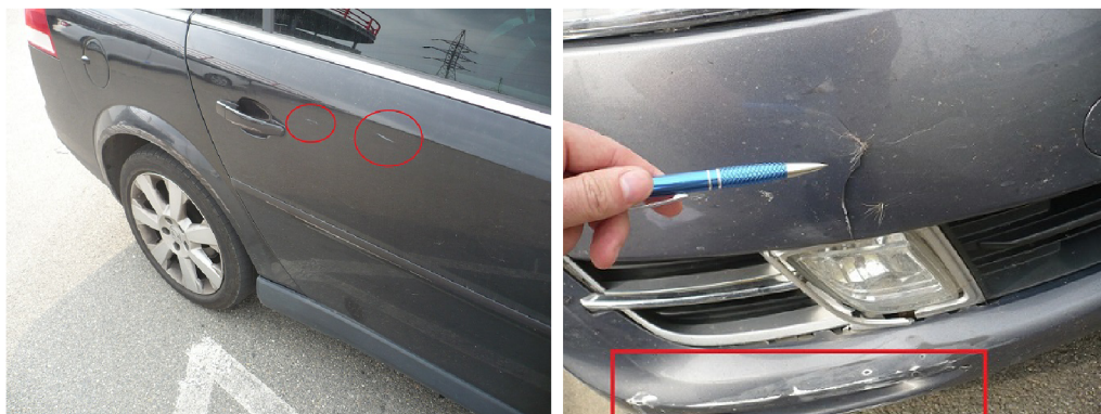
Obr. 6.3: Vozidla často obsahují poškození nesouvisející s PU. Vlevo jsou patrné oděrky laku, které nevznikly v následku PU – mají jinou barvu. Vpravo vozidlo poškozené sražením zvěře. Vyznačené poškození vzniklo jiným způsobem.
