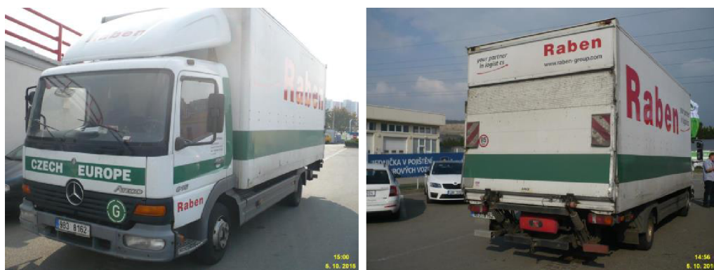
Obr. B.11: Pořízení šikmých průmětů vozidla jako nutná součást fotodokumentace vozidla Mercedes.
