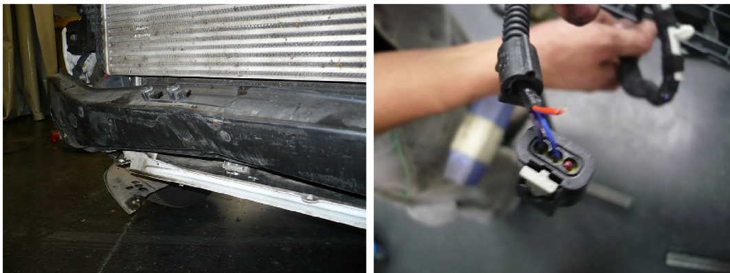
Obr. 5.1: Prohlídka po částečné demontáži odhalila skrytá poškození příčníku vpředu (vlevo) a elektroinstalaci předních parkovacích senzorů (vpravo).
