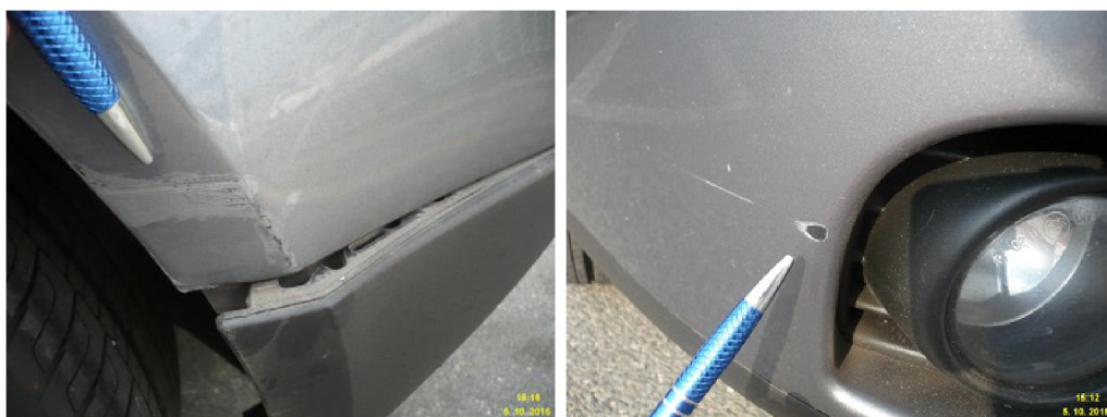
Obr. B.8: Vlevo je patrné poškození zadního nárazníku a předchozí opravy na LZ blatníku. Vpravo je poškození očividně nesouvisející s popsaným průběhem nehody.
