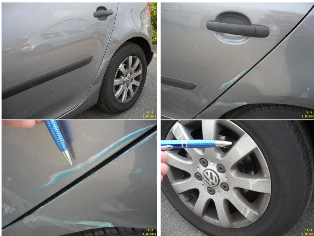
Obr. B.7: Poškození vozidla musí být pečlivě zdokumentováno. Volí se takové úhly záběru, aby bylo poškození co nejlépe patrné na fotografii.
