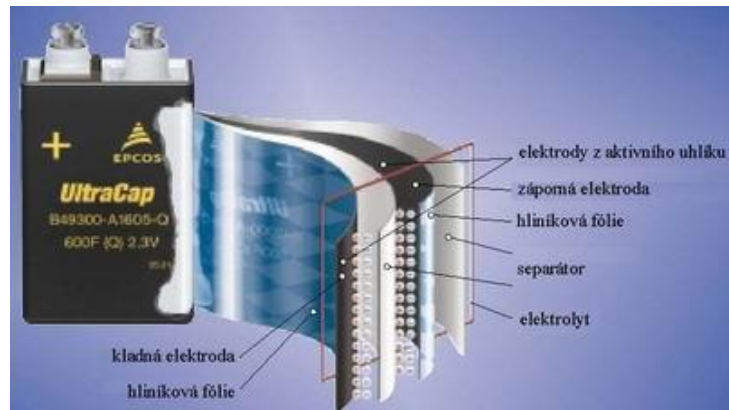
Obrázek 19. Struktura svitku superkondenzátoru[20]
