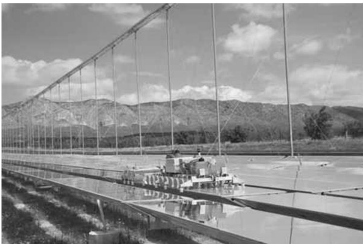
Obr. 3-6: Pohled na robota firmy Novatec pro suché čištění pohybujícího se reflektorovou linií [9] (s povolením Novatec Solar GmbH).
