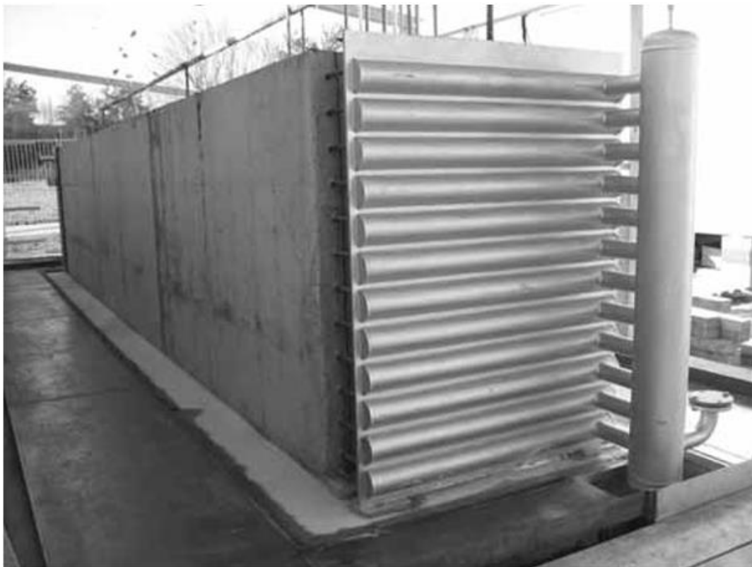
Obr. 10: Betonový skladovací modul (400 kWh) před instalací izolace (Steinmann, 2012).
