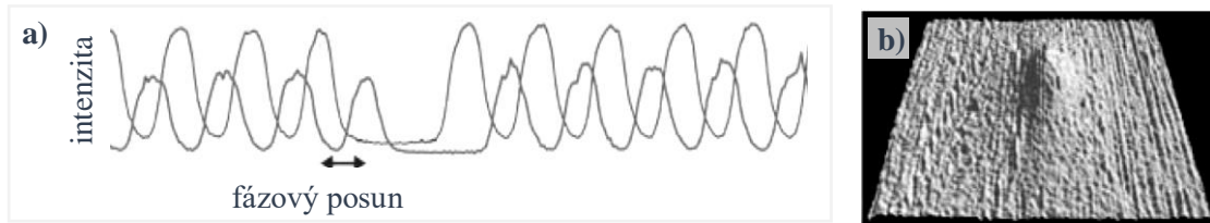
Obrázek 9: a) Fázové posunutí strukturovaného vzoru; b) DEM [15]
