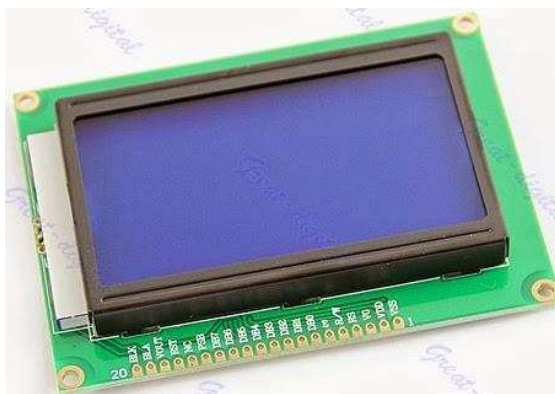
Obrázek 12. Grafický LCD displej 128x64 [30]
