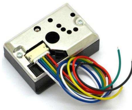
Obrázek 8. Senzor kvality ovzduší GP2Y1010AU0F [23]
