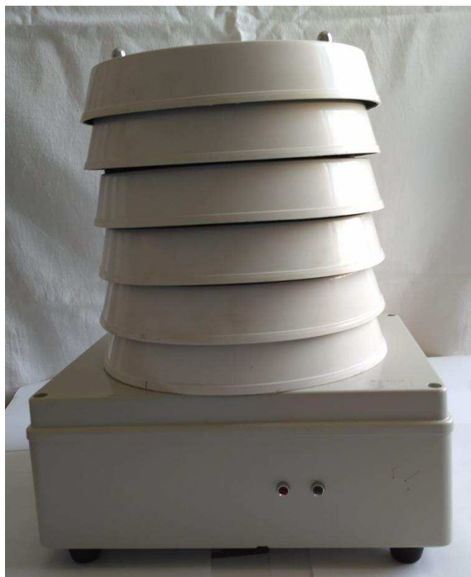
Obrázek 29. Čelní pohled sestavené meteorologické stanice
