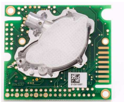
Obrázek 7. Modul senzoru koncentrace oxidu uhličitého K-30 [22]
