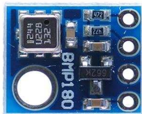
Obrázek 5. Modul senzoru tlaku BMP180 [20]
