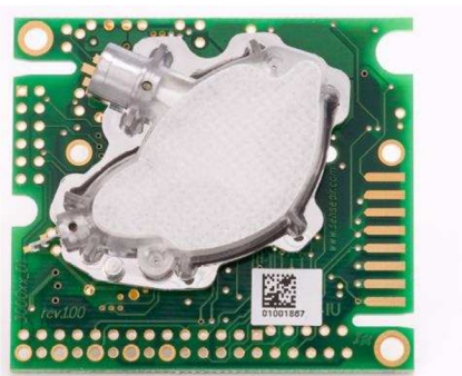
Obrázek 7. Modul senzoru koncentrace oxidu uhličitého K-30 [22]
