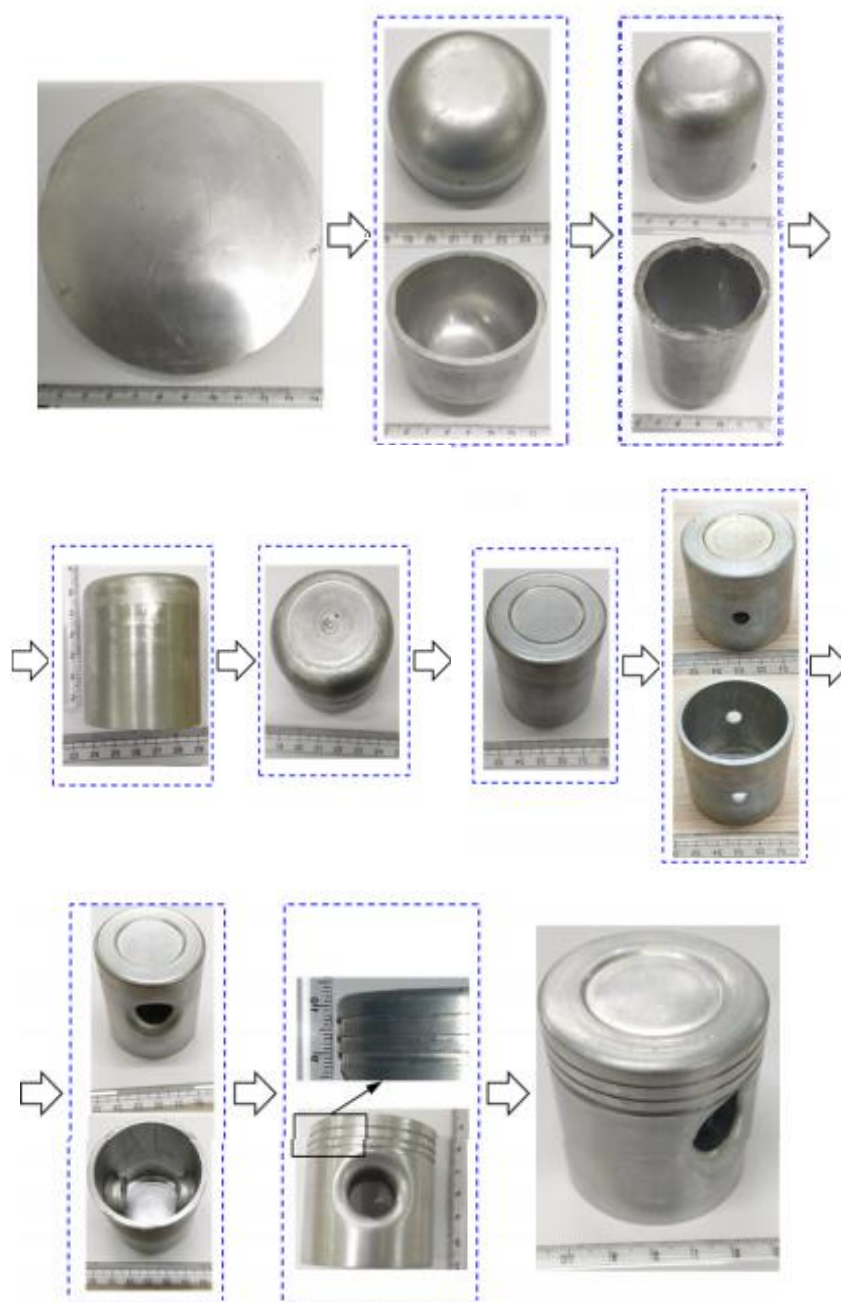
Obr. 16 - schéma výrobního postupu taženého pístu [19]
