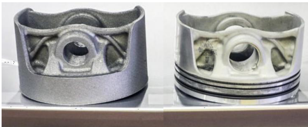
Obr. 32 – píst Porsche vyrobený aditivní technologií včetně obrobení [30]
