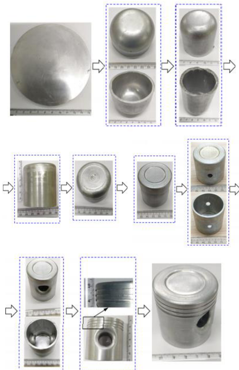
Obr. 16 - schéma výrobního postupu taženého pístu [19]
