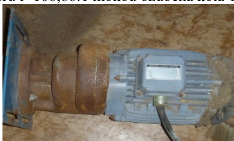
Obr. 29 Použitý elektromotor o výkonu 1,5 kW s převodovkou 13:1
