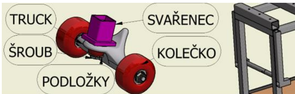
Obr. 43 Sestava přídavného kolečka (vlevo), madlo v klidové poloze (vpravo)
