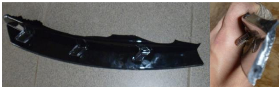
Obr. 19 Polykarbonátová (PC) část krycího skla světlometu Fabia III, připravená k drcení
