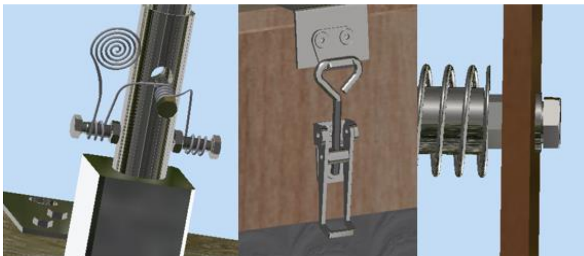
Obr. 41 Detail aretace (vlevo), detail stahovací spony (uprostřed), detail upevnění přitlačníku (vpravo)
