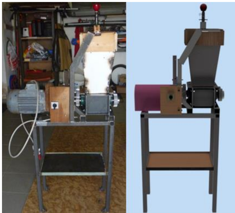
Obr. 47 Porovnání vyrobeného drtiče s CAD modelem vytvořeném v programu Autodesk Inventor Professional 2017
