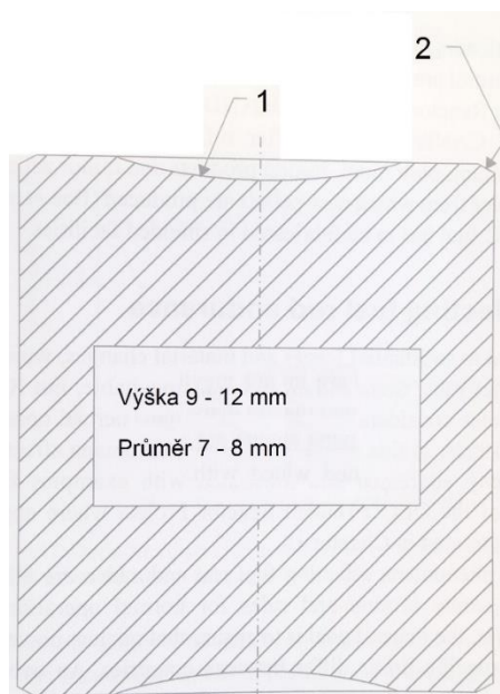
Obr. 4.6: Vyhotovená peleta: 1 – čochkovitě vydutí, 2 – zkosená obvodová hrana pelety [1]
