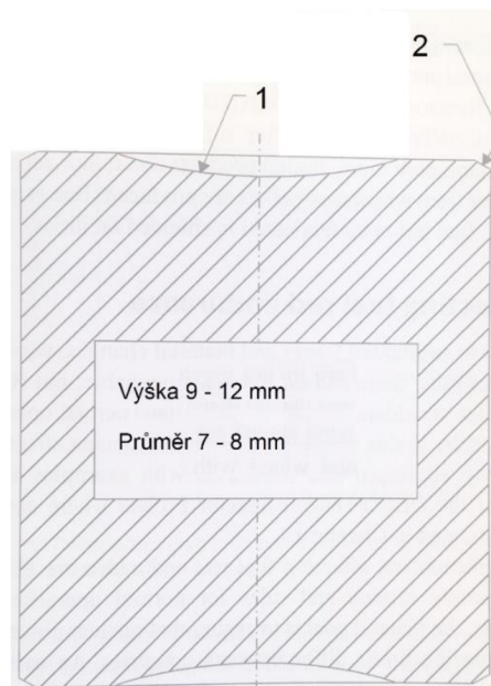
Obr. 4.6: Vyhotovená peleta: 1 – čočkovitě vydutí, 2 – zkosená obvodová hrana pelety [1]
