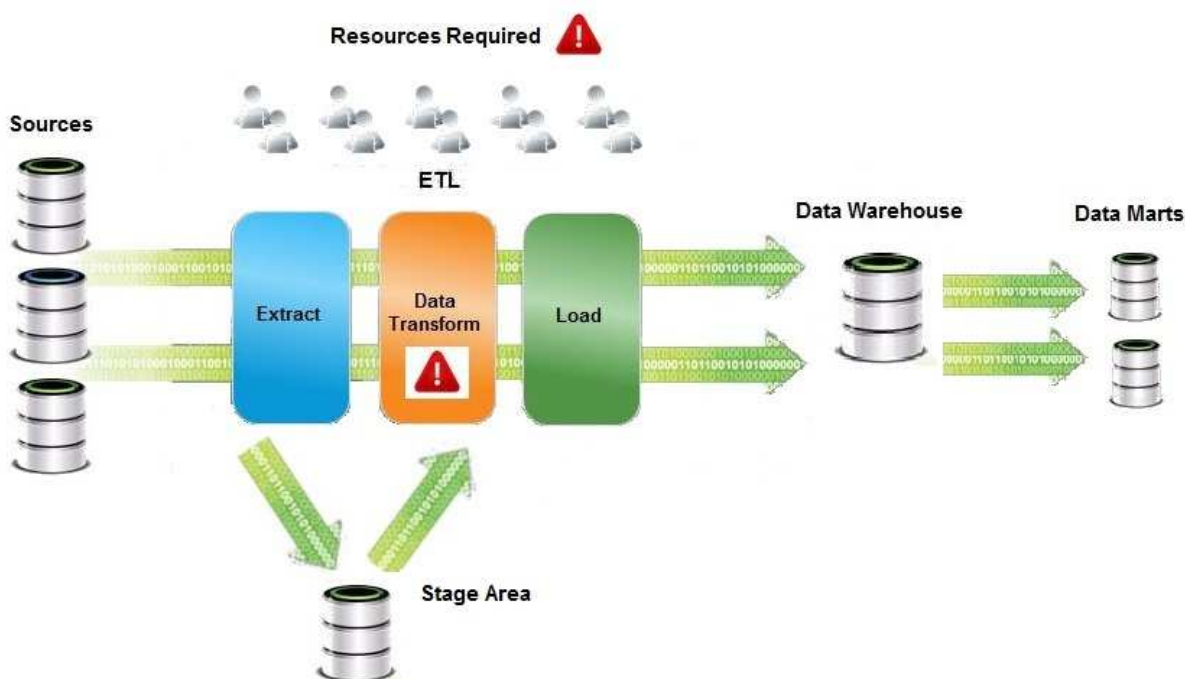
Obr. 8: ETL schéma zpracování dat; Zdroj: [2]
