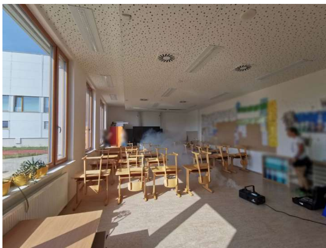
Obrázek 41: Zkouška proudění vzduchu v učebně pomocí vyvíječe páry [autor]
