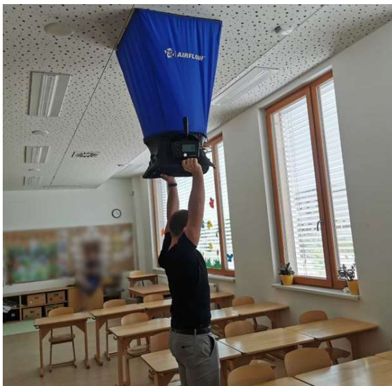
Obrázek 37: Měření průtoku na vyústce VZT [autor]
