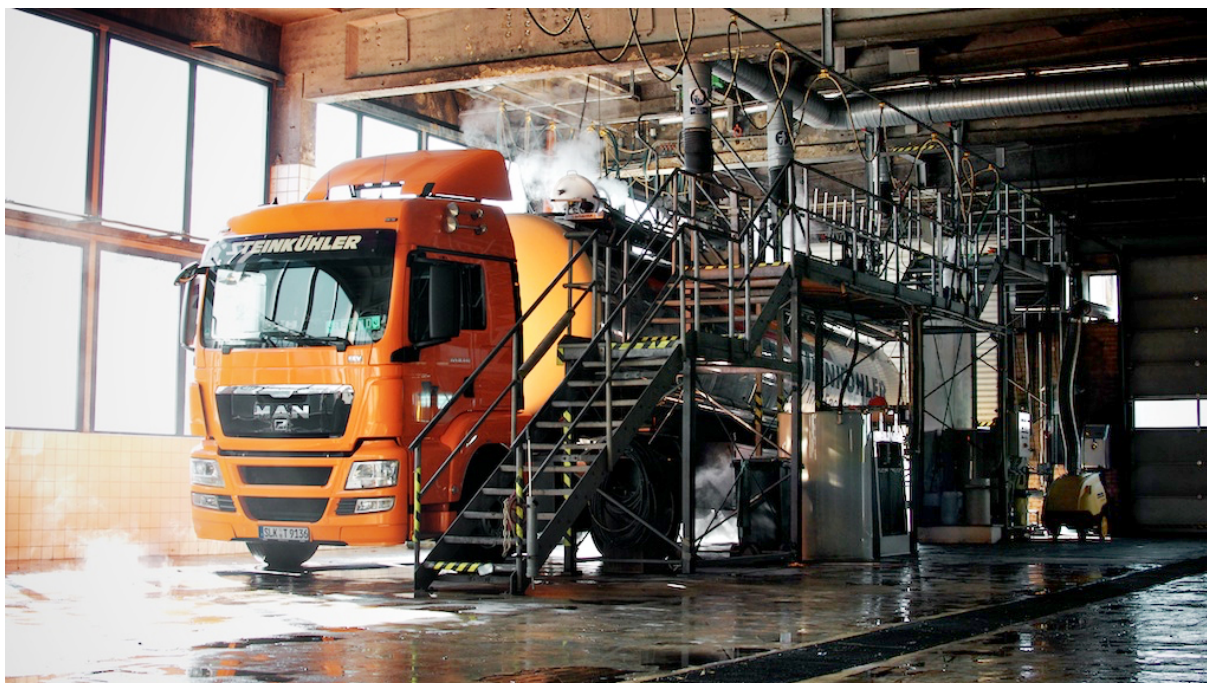
Obrázek 1: Probíhající čištění cisterny v čisticí stanici
