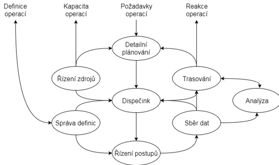
Obr. 2-5 Generický model řízení výroby (dle normy ČSN 62264-3 ed. 2)
