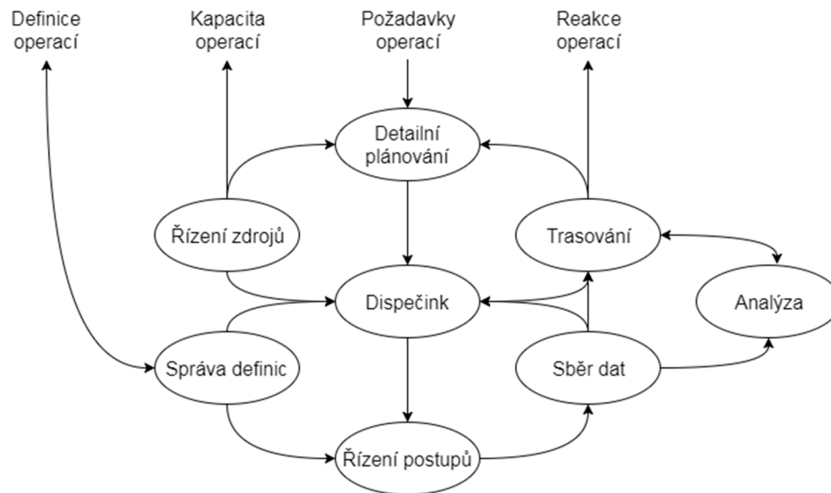
Obr. 2-5 Generický model řízení výroby (dle normy ČSN 62264-3 ed. 2)
