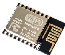
Obrázek 4.9: Samostatný ESP8266 čip. Převzato z [8].
