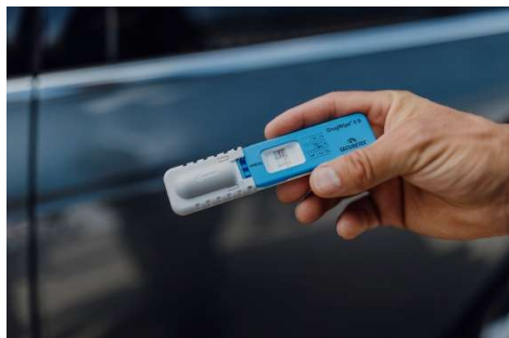
Obrázek 14 - Orientační test DrugWipe 5S
