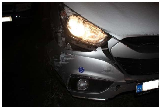
Obrázek 34 - Poškození v p. p. části OA Hyundai
