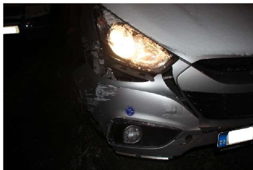
Obrázek 34 - Poškození v p. p. částí OA Hyundai
