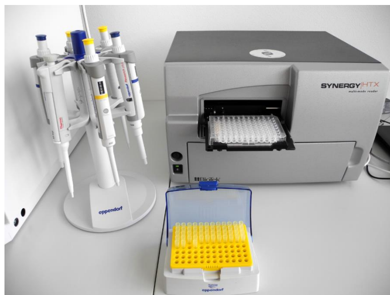
Obr.15 – Microplate Reader použitý k měření fluorescence/absorbance
